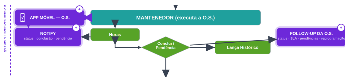
Figura 46 — Camada de execução: mantenedor, aplicativo móvel, apontamento de horas, tratamento de pendências, histórico e follow-up. Fonte: elaborado pelo autor.
