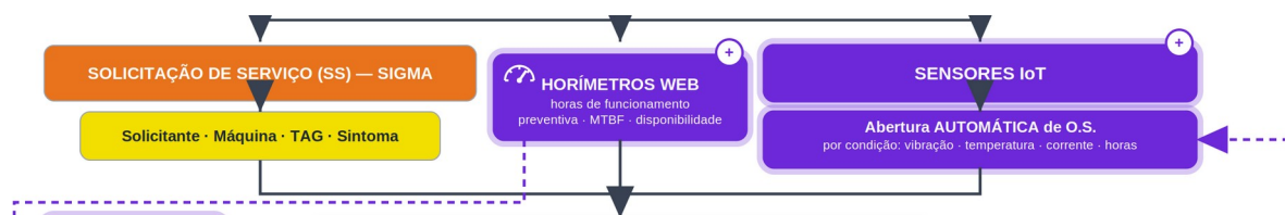
Figura 15 — Camada de demanda: solicitação de serviço, horímetros web e sensores IoT convergindo para a geração da O.S. Fonte: elaborado pelo autor.
